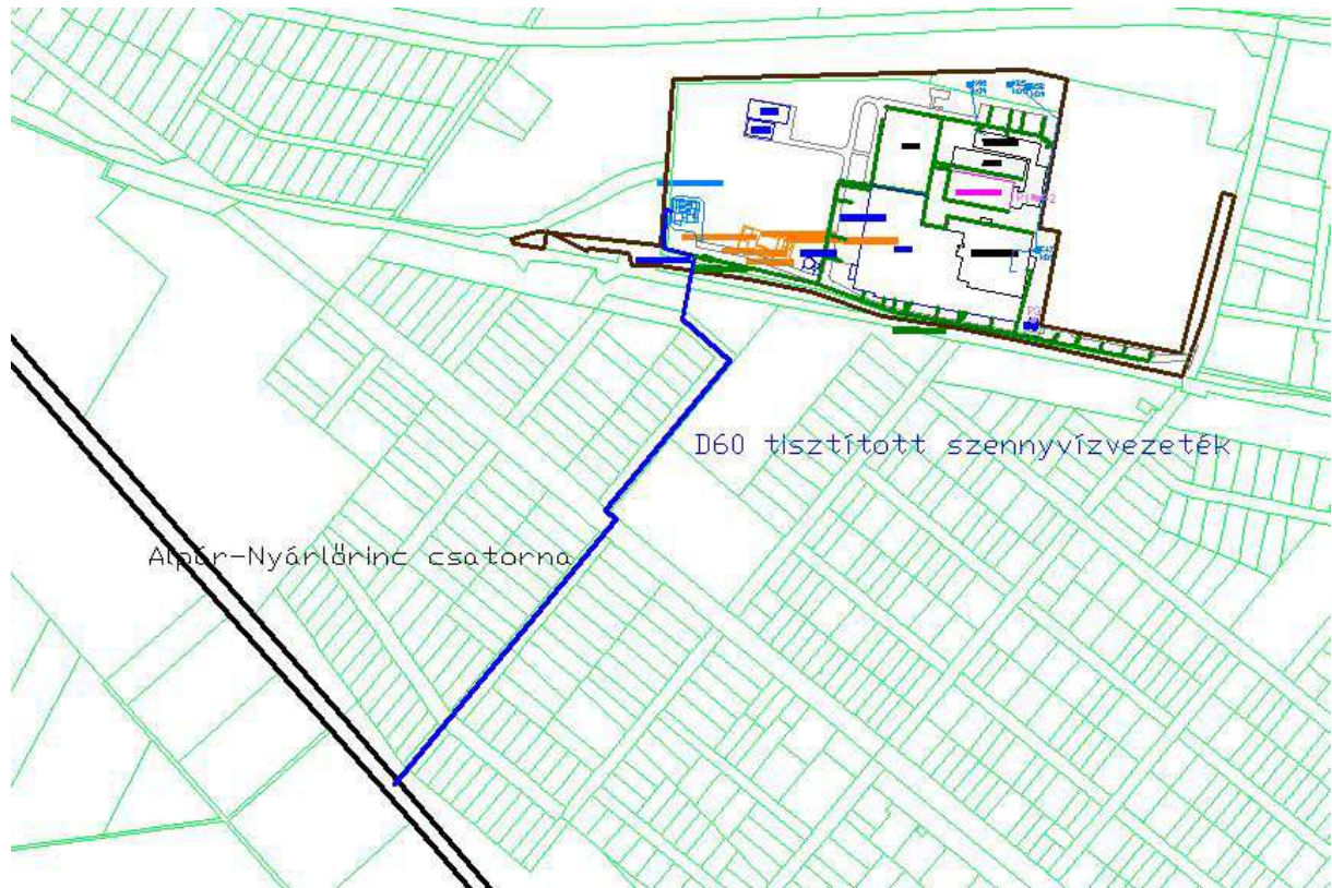
2-2. ábra: A szennyvíztisztító tervezett helye és a tisztított szennyvizek befogadója, az Alpár-Nyárlőrinci csatorna elhelyezkedése
